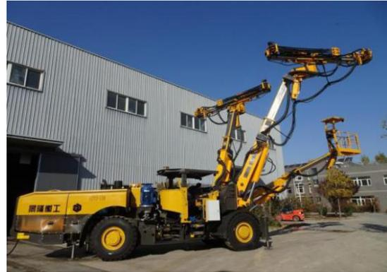
LZT3-110两臂轮式自动化隧道锚杆台车
