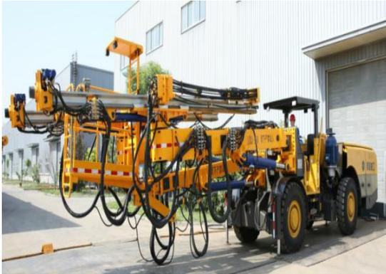
LCM3-110两臂轮式隧道锚杆台车
