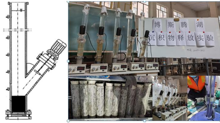
图 20 室内模拟沉积物释放装置及现场样品采集图
